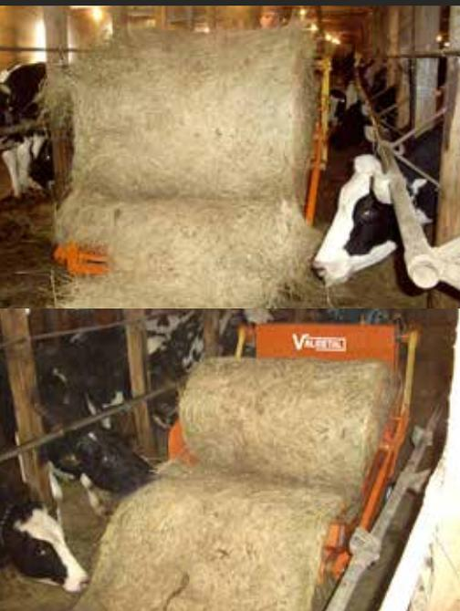
Automatikspannrollen sorgen für eine konstante Spannung auf den zwei Ketten des Förderwerks. Der Rundballen-Abroller wird von einem Honda-Motor mit 9 PS und einer leistungsstarken hydrostatischen Pumpe angetrieben.
