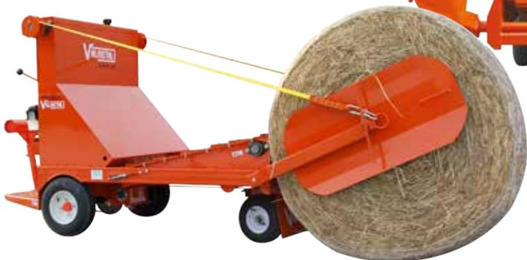
Eine Winde mit zwei Kabeln, die mit einem Set von teleskopischen Armen verbunden ist, lädt die Ballen sicher auf den Wagen (keine Rampe erforderlich).
