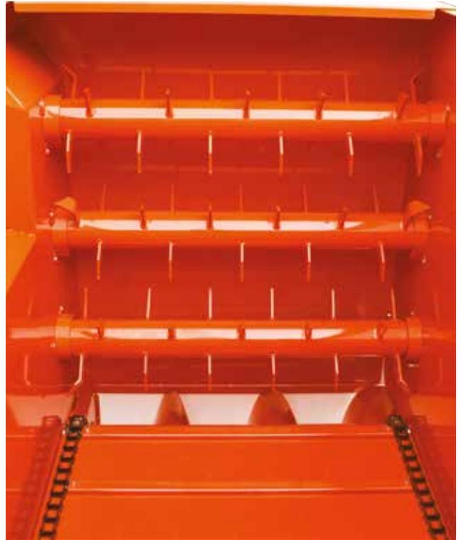
Schürze mit schweren U-Profil-Stahlschienen für Festigkeit und Widerstandsfähigkeit
